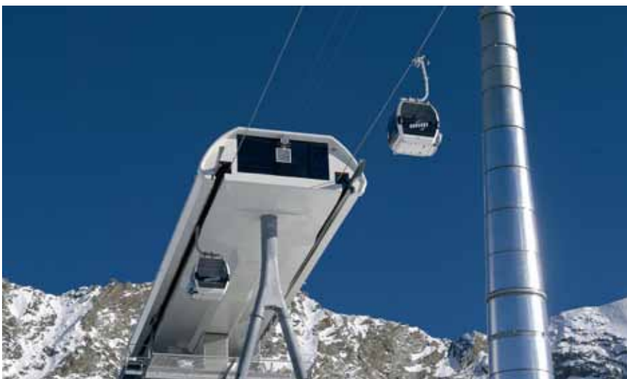
Die Salzmänn GmbH fertigt z.B. Blechverkleidungen für die Doppelmayr/Garaventa-Gruppe , den weltweit führenden Hersteller im Seilbahnwesen. Quelle: Salzmänn GmbH
